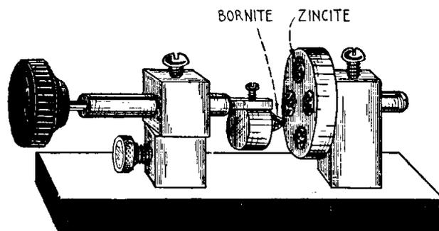
Fig. 159—The Zincite Bornite Detector.
