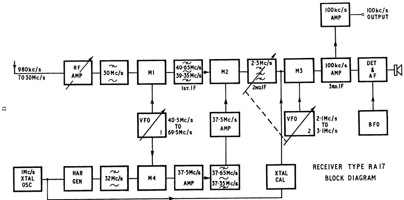
FIG. 1 BLOCK DIAGRAM OF THE RECEIVER TYPE RA.17
