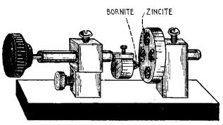
Fig. 159-The Zincite Bornite Detector.
