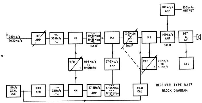
FIG. 1 BLOCK DIAGRAM OF THE RECEIVER TYPE R.A17
