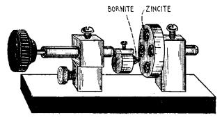
Fig. 159-The Zincite Bornite Detector.
